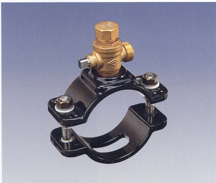
サドル分水栓(協会型) ●管種/石綿、鋳鉄、ポリ、ビニル ●バンド寸法/40~350mm(口径13~25mm) 75~300mm(口径30~50mm)
